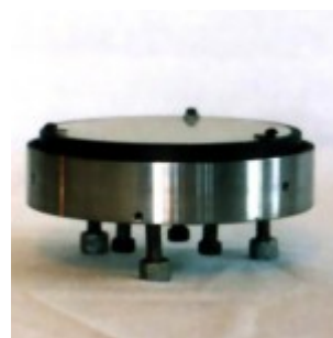
Оправа 125-мм зеркала в сборе
