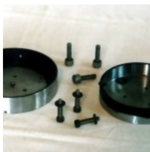
Оправа 125-мм зеркала в разборе
