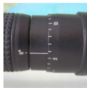
Фокусирующая и панкратическая система
