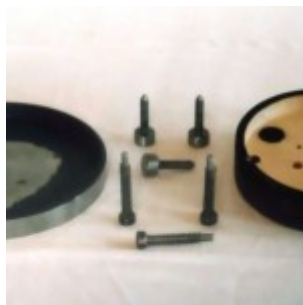
Оправа 150-мм зеркала в разборе
