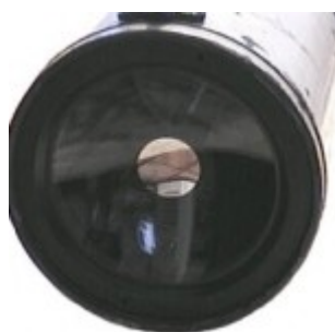
Вторичное зеркало нанесено непосредственно на мениск
