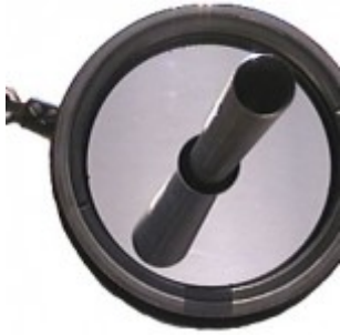
Трубка-отсекатель и задний диоптр с зеркальцем
