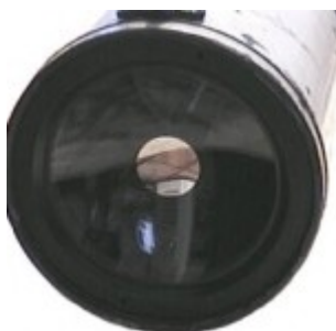
Вторичное зеркало нанесено непосредственно на мениск
