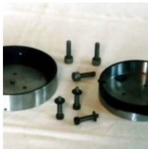
Оправа 125-мм зеркала в разборе
