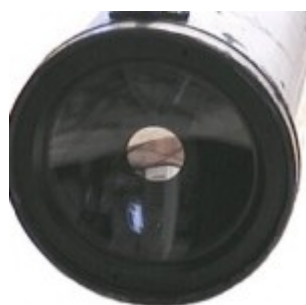
Вторичное зеркало нанесено непосредственно на мениск
