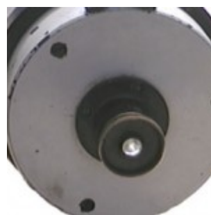
Окулярный узел и винты юстировки
