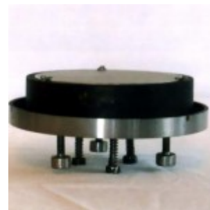
Оправа 150-мм зеркала в сборе
