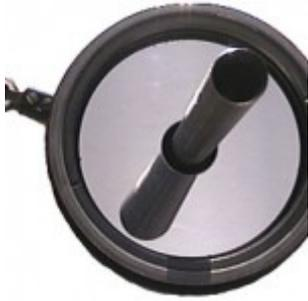
Трубка-отсекатель и задний диоптр с зеркальцем
