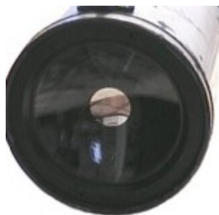
Вторичное зеркало нанесено непосредственно на мениск
