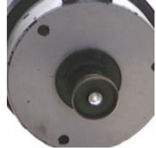
Окулярный узел и винты юстировки
