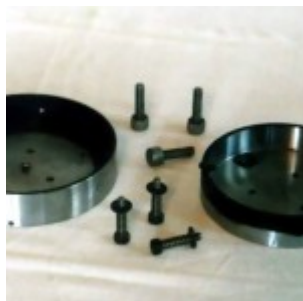
Оправа 125-мм зеркала в разборе
