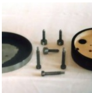
Оправа 150-мм зеркала в разборе
