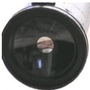
Вторичное зеркало нанесено непосредственно на мениск
