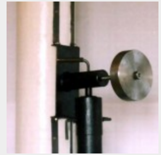
Крепление трубы к монтировке
