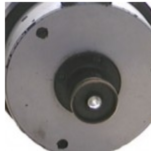
Окулярный узел и винты юстировки
