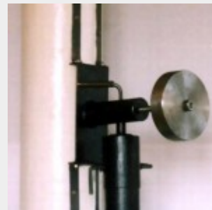
Крепление трубы к монтировке
