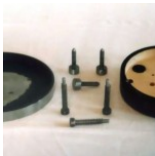
Оправа 150-мм зеркала в разборе
