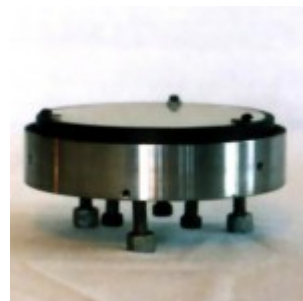
Оправа 125-мм зеркала в сборе
