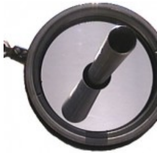
Трубка-отсекатель и задний диоптр с зеркальцем
