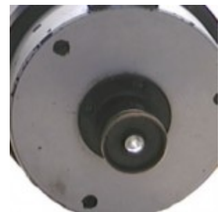
Окулярный узел и винты юстировки
