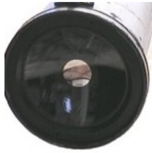
Вторичное зеркало нанесено непосредственно на мениск
