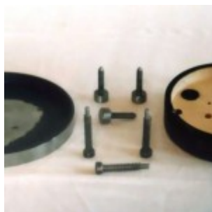
Оправа 150-мм зеркала в разборе
