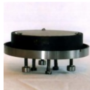
Оправа 150-мм зеркала в сборе
