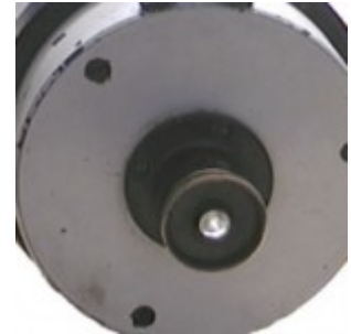
Окулярный узел и винты юстировки
