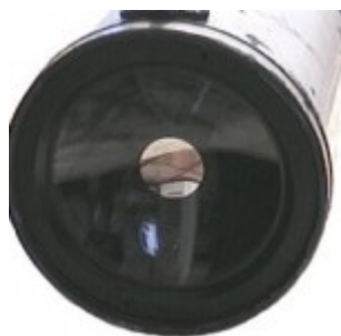
Вторичное зеркало нанесено непосредственно на мениск
