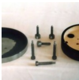
Оправа 150-мм зеркала в разборе
