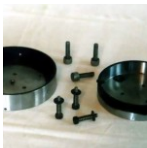
Оправа 125-мм зеркала в разборе
