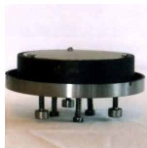
Оправа 150-мм зеркала в сборе
