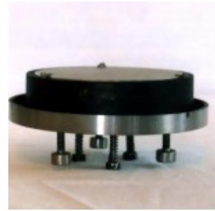
Оправа 150-мм зеркала в сборе
