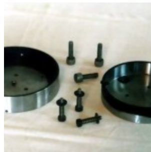
Оправа 125-мм зеркала в разборе
