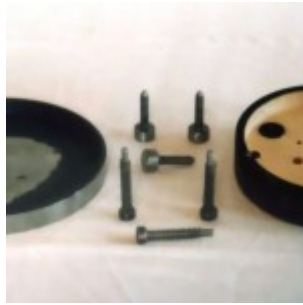
Оправа 150-мм зеркала в разборе
