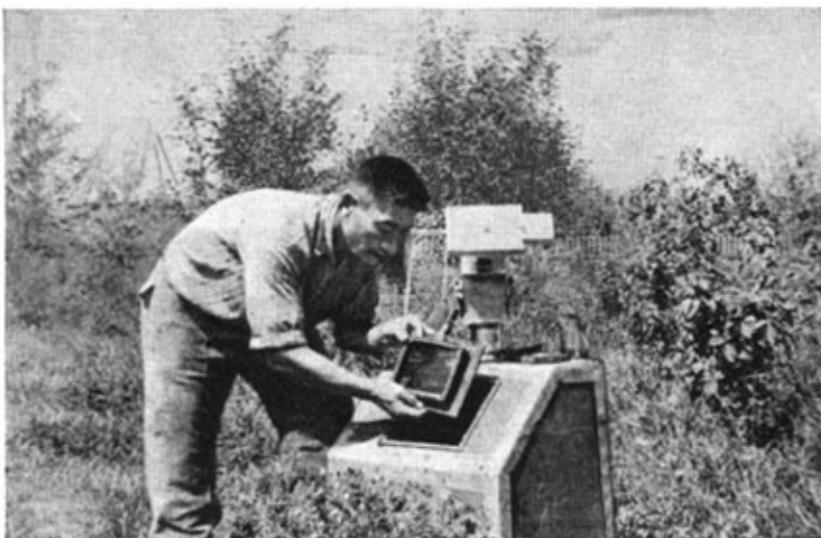
Фото 3. Флуоресцентный ящик со спектрографом.
