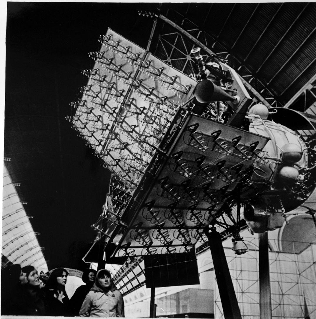
Спутник "Экран", обеспечивающий ретрансляцию программ Центрального телевидения на приемные устройства коллективного пользования.
